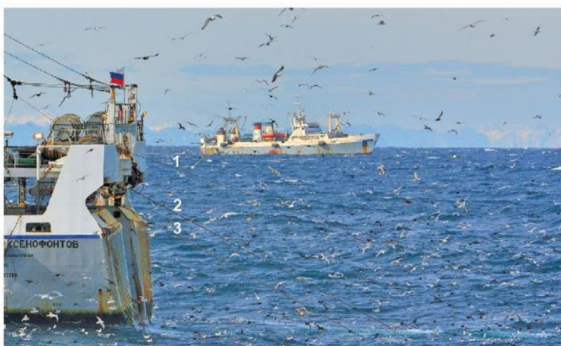
Figura 3. La aparición de un arrastrero de gran tonelaje del tipo BMRT y la ubicación del cable de tercer hilo de red (1), (2) urdim y urdimbre izquierda (3) en la etapa de arrastre
